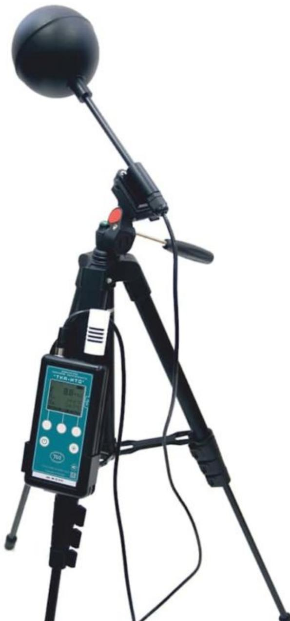
Принцип действия измерителя состоит в преобразовании падающего на чёрный шар теплового потока в электрический сигнал, пропорциональный плотности этого потока (облучённости), с последующим масштабированием и индикацией результата измерения.
