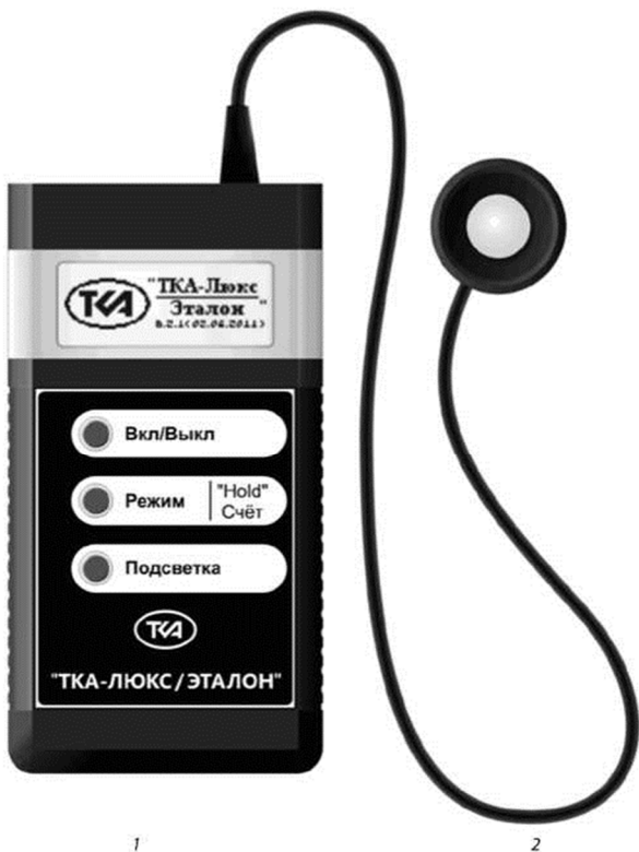
Рис. 1. Внешний вид Люксметра 1 – блок обработки сигнала, 2 – фотометрическая головка
