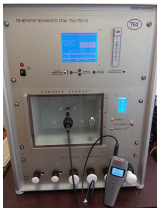
Рисунок 5. Расположение измерительного зонда контрольного термогигрометра в рабочей камере генератора ТКА-ГВЛ-03
