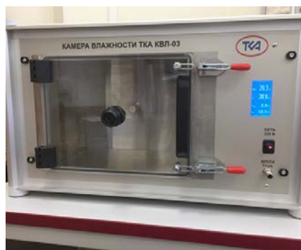
Рисунок 4. Камера влажности ТКА-КВЛ-03, рабочий объем 8,3 литра
