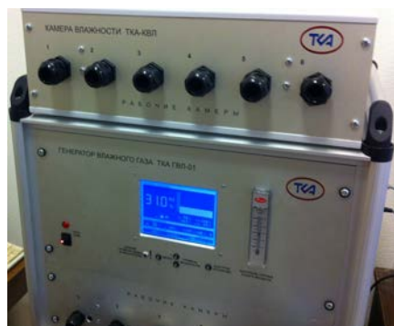
Рисунок 3. Камера влажности ТКА-КВЛ с 6 рабочими портами
