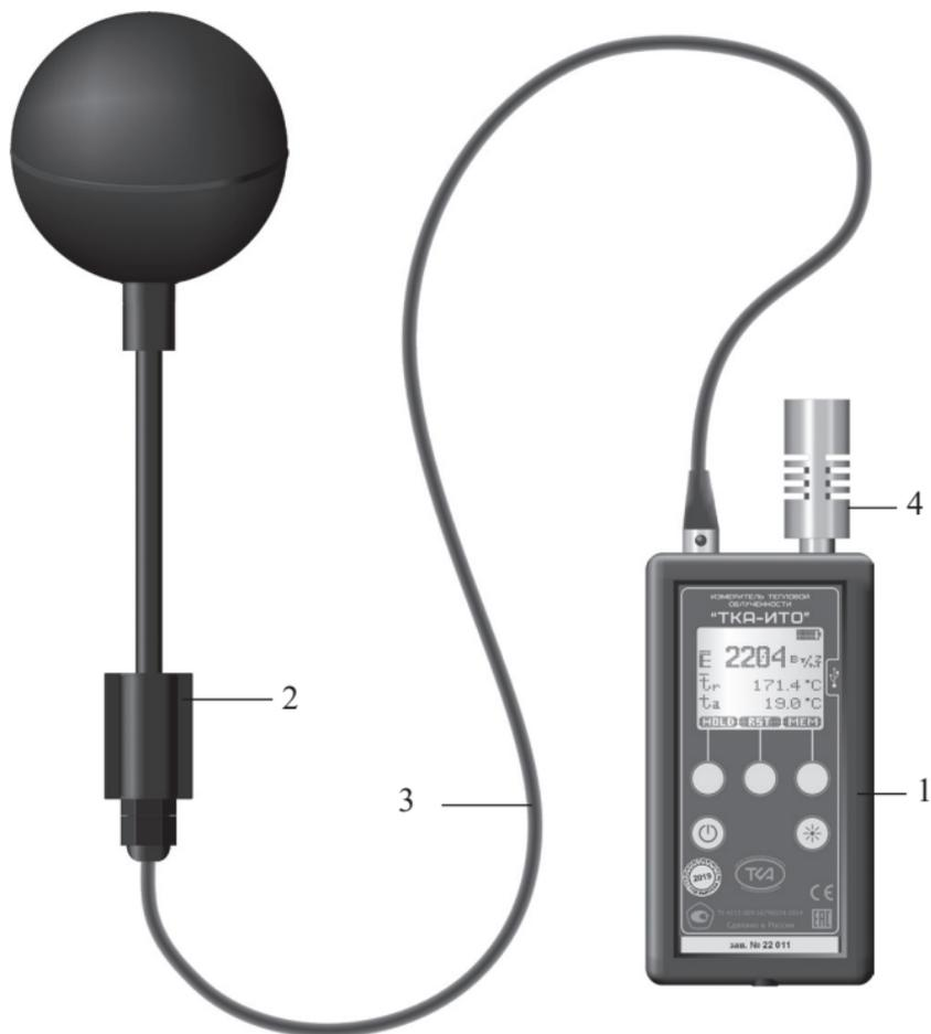
Рис.1 – Внешний вид прибора “ТКА-ИТО”.
