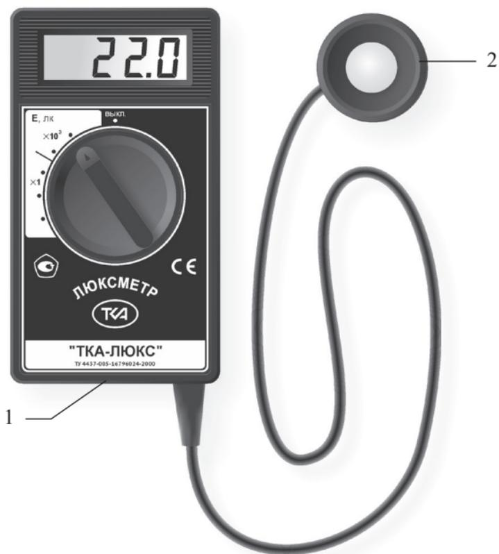
Рис.1 Внешний вид прибора “ТКА-Люкс”
