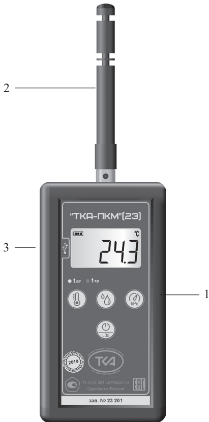
Рис.1 – Внешний вид прибора “TKA-ПКМ”(23) 1 – Блок обработки информации 2 – Измерительная головка 3 – Разъём для подключения к ПК
