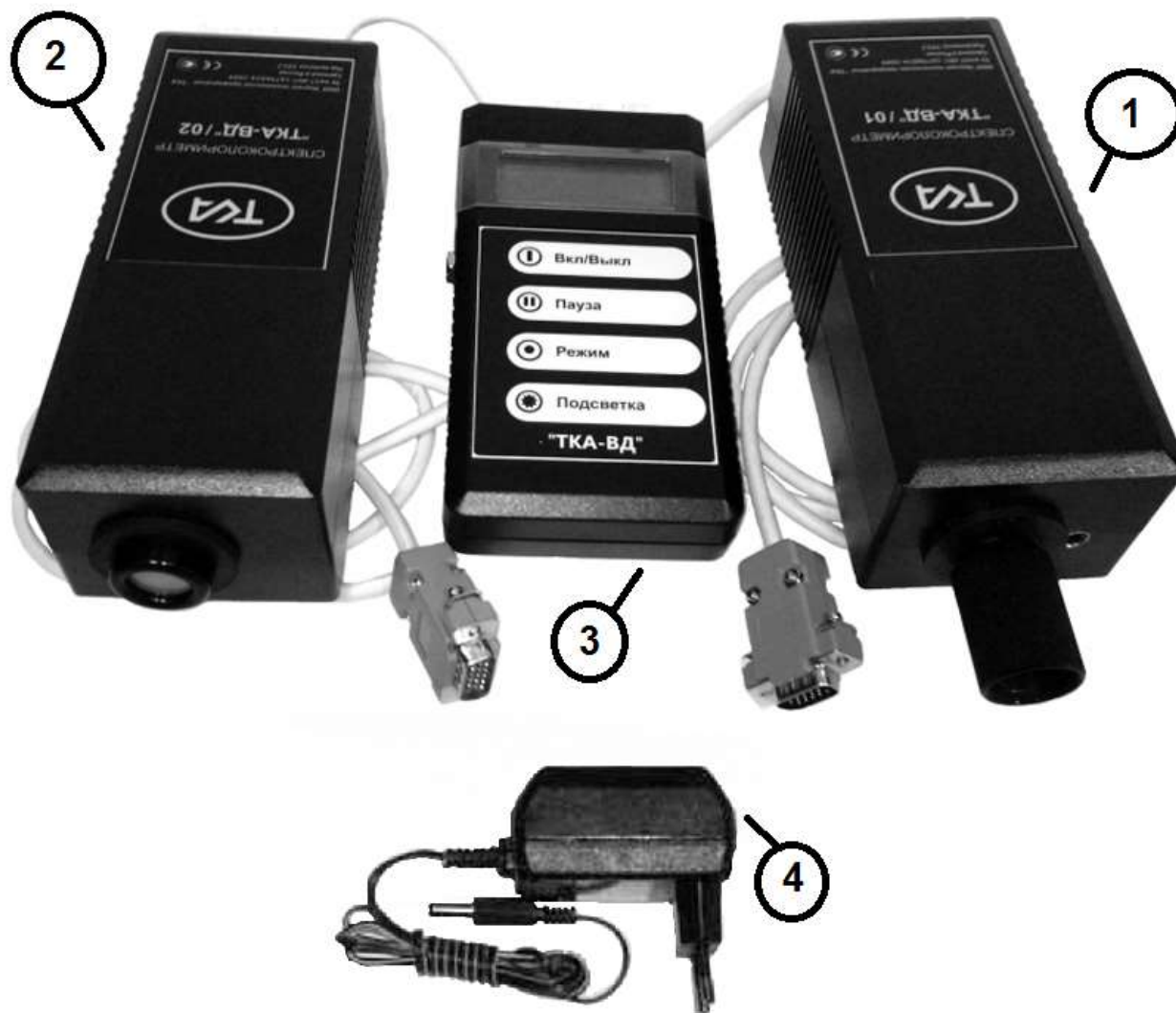
Рисунок 1. Внешний вид прибора 1 – оптоэлектронный блок - 01 2 – оптоэлектронный блок - 02 3 – блок обработки сигнала 4 – сетевой блок питания
