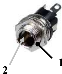
Рис. 3. Разъем “DC IN” (гнездо) 1 – плюс питания (корпус разъёма), 2 – минус питания (центральный штырь)
